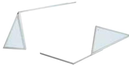
2. Installer les vitres, en les faisant glisser sur les rails ou en alignant par la partie supérieure
